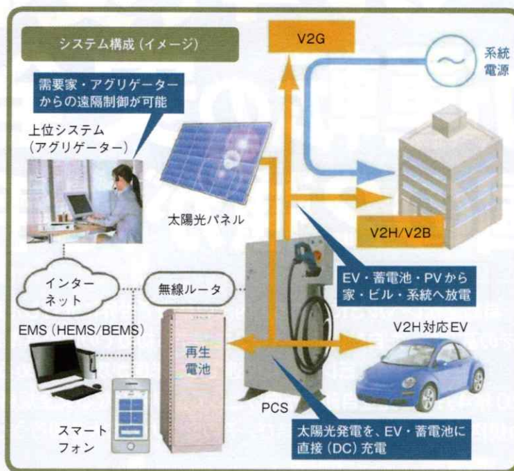
図8 「V2X付蓄電池」の使用例 太陽電池パネルと組み合わせて使えるほか、EVやPHEVとも電力のやり取りができる。(出所：4R)
