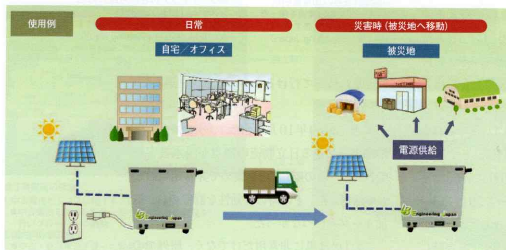
図7 「LB-D4-A14S」の使用例 LB-D4-A14Sは、Bグレードの電池モジュールを14個使った大容量モデルで、太陽電池パネルと組み合わせて使える。（出所：L-B.Engineering Japan）
